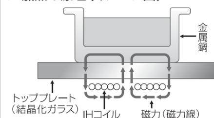
IHとはInduction Heatingの略で、日本語では電磁誘導加熱といいます。トッププレート下のIHコイルに電流を流し、磁力(磁力線)によりトッププレート上に置いた金属鍋自体を発熱させます。
