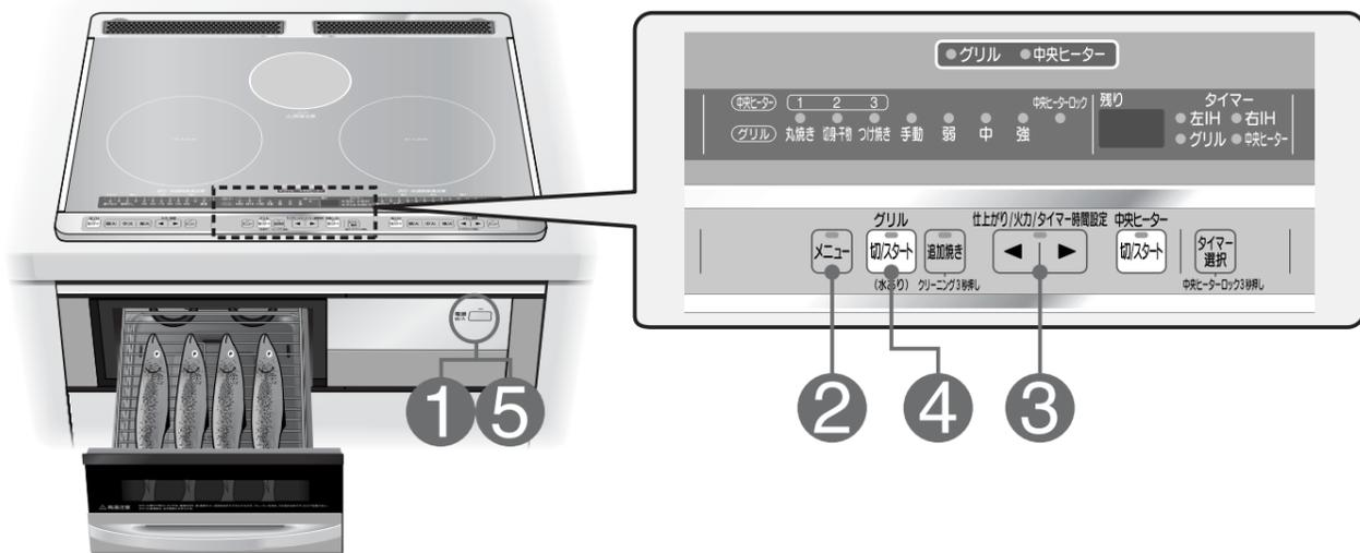
**準備** 受皿に水(200mL)を入れ、材料を焼網の上に置き、グリルドアを確実に閉める
