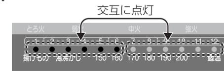
約30秒後にブザーが鳴り、表示が消え、自動的に通電を停止します。
