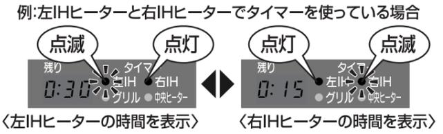
電源を入れ、火力を選び、**切スタート** を押した後の通電中（調理中）に設定する
